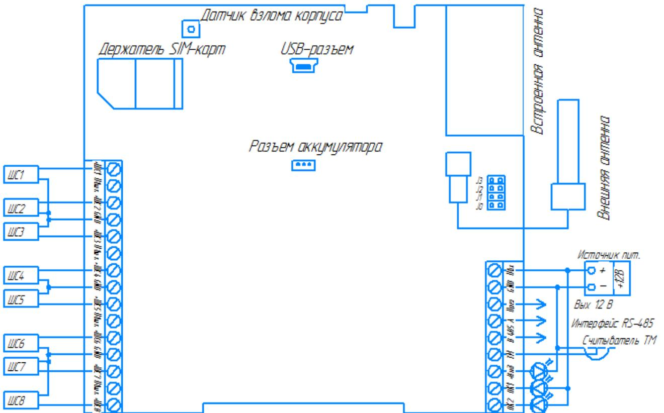
Рисунок 2.6. Назначение разъемов УОО «Сатурн-2813» и УОО «Сатурн-2814»
