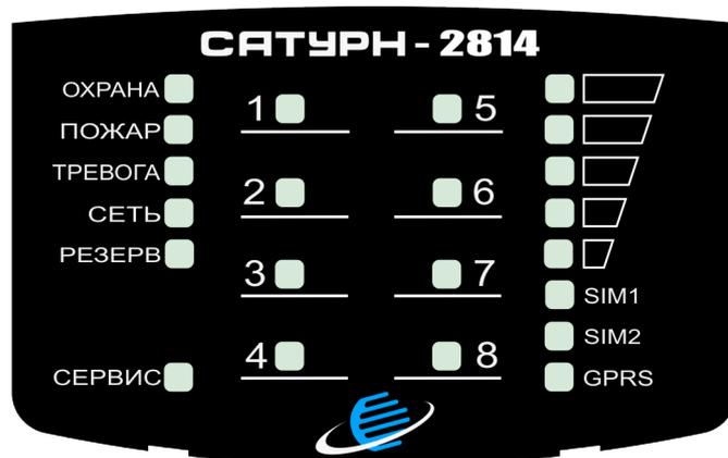
Рисунок 2.5. Панель индикации УОО в исполнении Сатурн-2814
